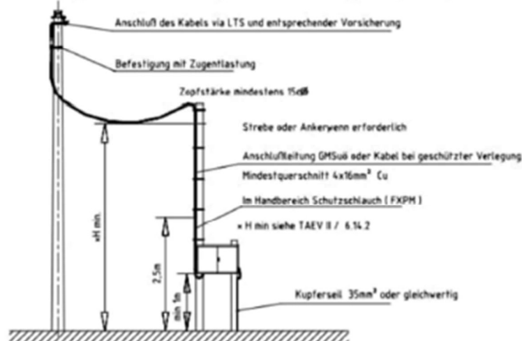
Abb. 2: Montage bei einer Entfernung bis 4m vom Niederspannungsstützpunkt
